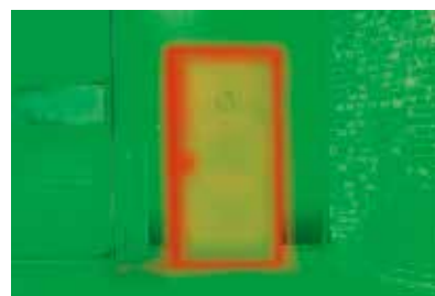
Sichtbarer Energieverlust ohne thermisch getrennte Tür
