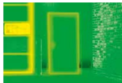
Deutlich geringerer Energieverlust dank thermisch getrennter Tür
